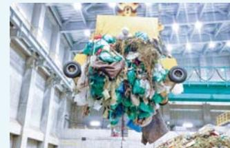
焼却炉にごみを投入する前に、ごみクレーンを使ってごみを十分に攪拌し、水分量などごみの性状を均一にすることで、ごみの燃焼が安定し、排ガス状況も安定します。
